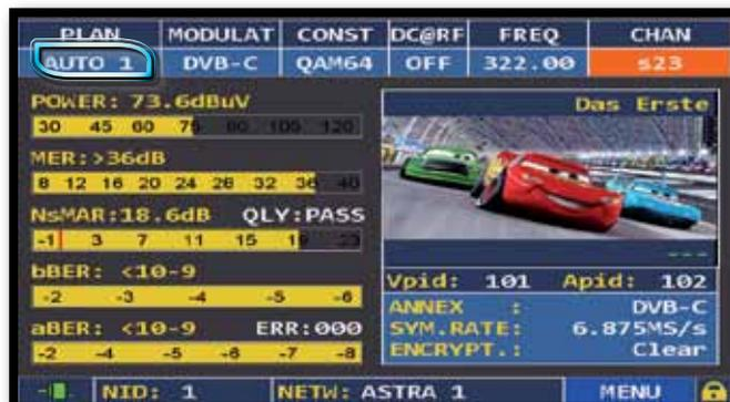
UPON AUTOMEMORY COMPLETION THE NEW PLAN IS AUTOMATICALLY SELECTED.
